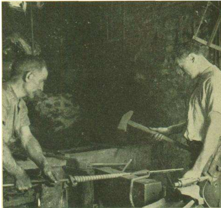
FABRICATION DES CANONS DAMAS Enroulement d'un ruban sur le mandrin Nessonvaux, 1925. « Archives du Musée de la Vie Wallonne
